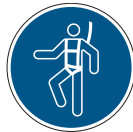
M018: Auffanggurt benutzen
