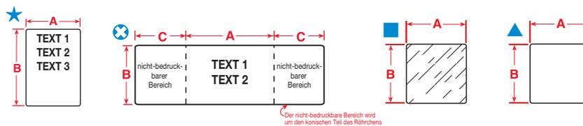
Der nicht-bedruckbare Bereich wird um den konischen Teil des Röhrcchens gestülpt und sichert das Etikett.
